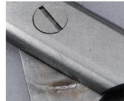
Antes de lubricar, los instrumentos deben haberse enfriado a la temperatura ambiente. De lo contrario, existe el riesgo de que se produzca abrasión metálica entre las partes
