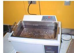
Existen máquinas lavadoras de sobremesa que no son validables y también existen otras que tienen dos compartimentos: un compartimento para el lavado con ultrasónico, prepara la solución cada vez que lava, tiene adaptadores para lavar lúmenes y otro compartimento para el enjuague, que es automático, con ultrasonido y agua desmineralizada.
